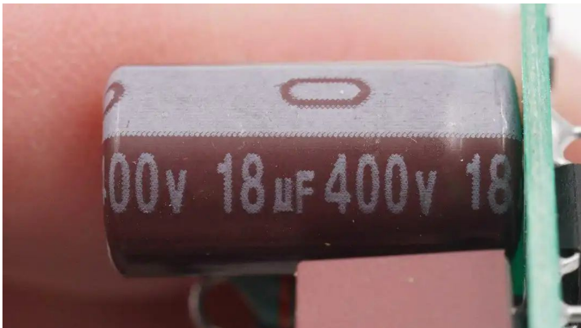
高压滤波电解电容规格为18 \mu F 400V，两颗并联。
