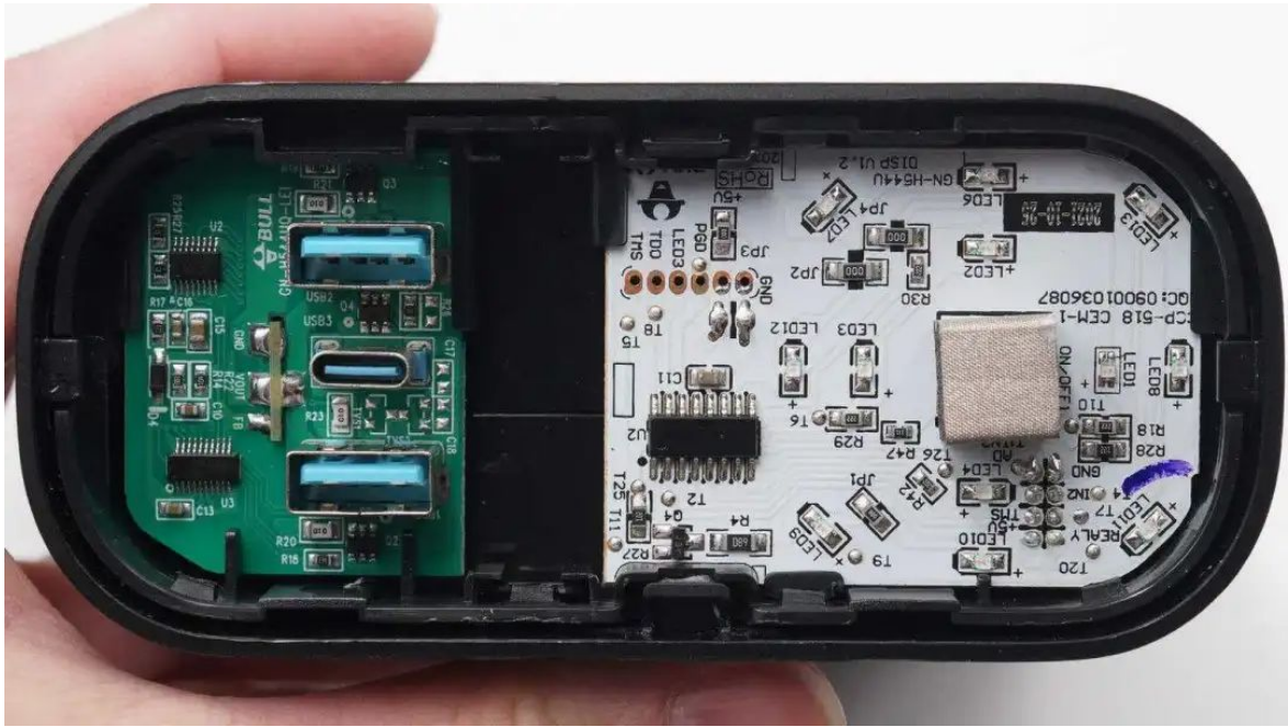
插座内部可以看到绿色快充模块的电路板和白色触摸模块的电路板。其中白色触摸模块的电路板上还焊接了状态指示灯。
