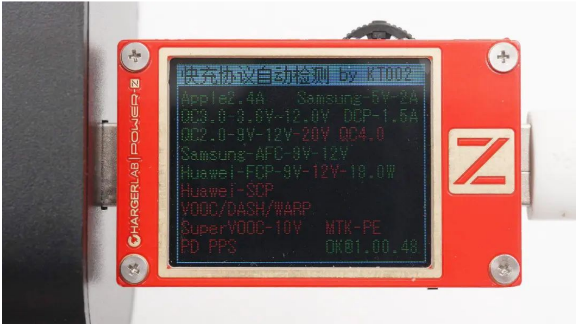
使用ChargerLAB POWER-Z KT002测得插座两个USB-A口兼容协议相同，均支持QC2.0/3.0、AFC、FCP快充协议。
