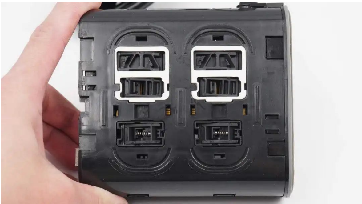
插座火线与零线插孔均有安全门保护，防止异物单边插入造成触电风险。
