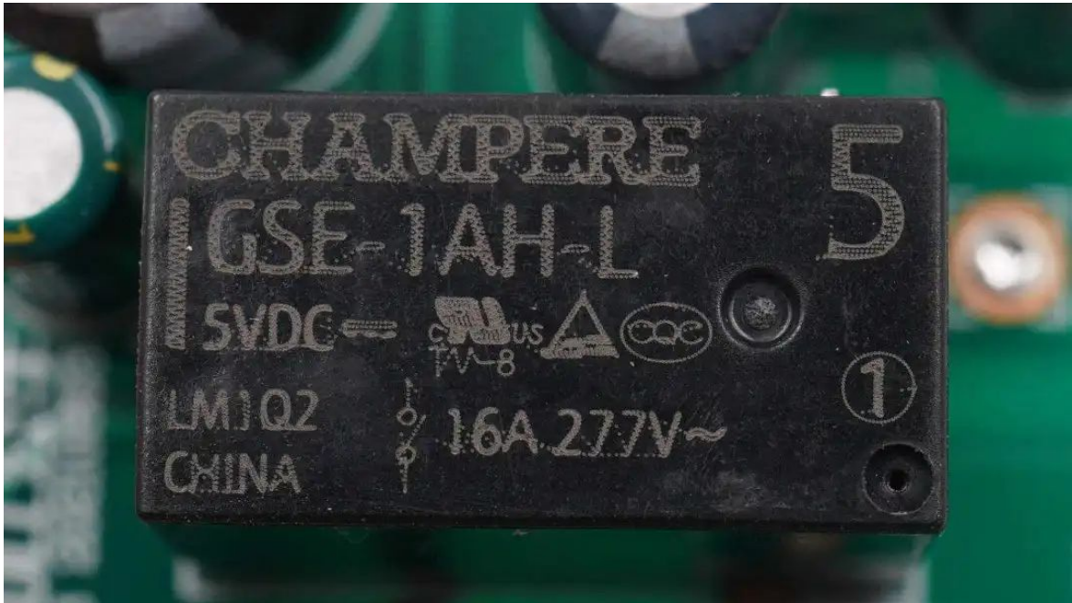
控制交流电源输出的继电器，来自宁波嘉冠电子，GSE-1AH-L，线圈驱动电压为5V，触点容量16A。
