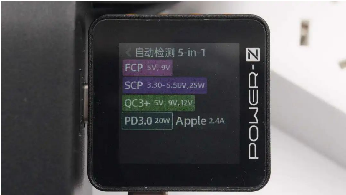
使用ChargerLAB POWER-Z KM002C测得USB-C口支持QC3+、FCP、SCP、PD3.0快充协议。
