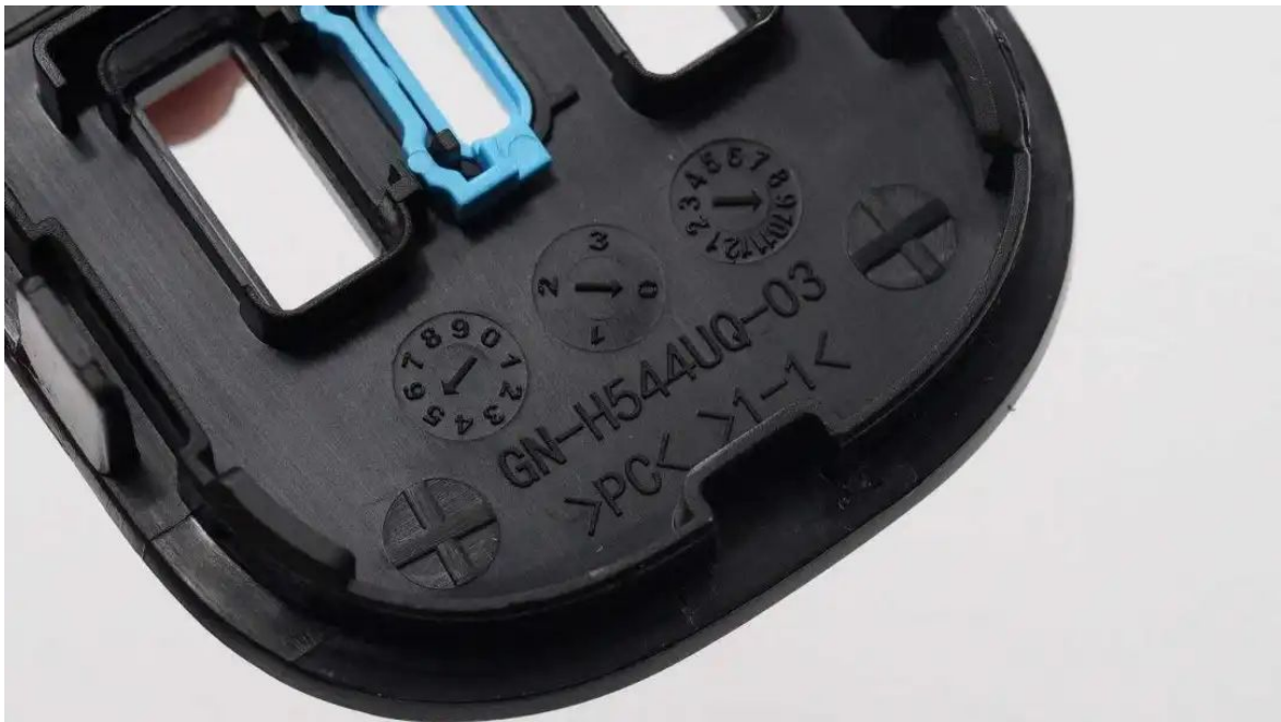
壳体内部为生产日期和产品型号信息，外壳采用PC材质。
