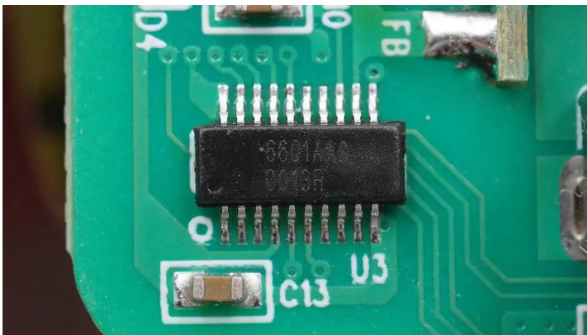
快充模块使用天德钰FP6601AA协议芯片控制输出电压，支持单口快充，双口5V输出，芯片支持QC2.0/3.0、FCP等快充协议，支持多颗芯片协同工作。
